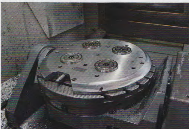
Bild 4: Auf der DMG-Maschine macht sich die durch das AMF-Nullpunktspannsystem K20 gewonnene Flexibilität besonders bemerkbar
