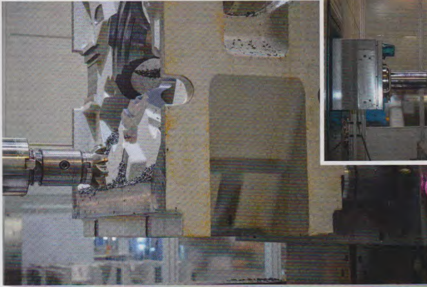
Bild 1: Die extrastarken AMF-Module K40-H realisieren bei einem Durchmesser von 148 mm 40 kN Einzugs-/Verschlusskräfte sowie 105 kN Haltekraft
